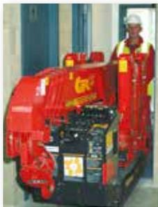
**Avec une largeur de 600 mm, l'URW-095 est spécifiquement conçue pour l'accès intérieur et profite d'une capacité de levage bien supérieure à sa catégorie de grues.**
